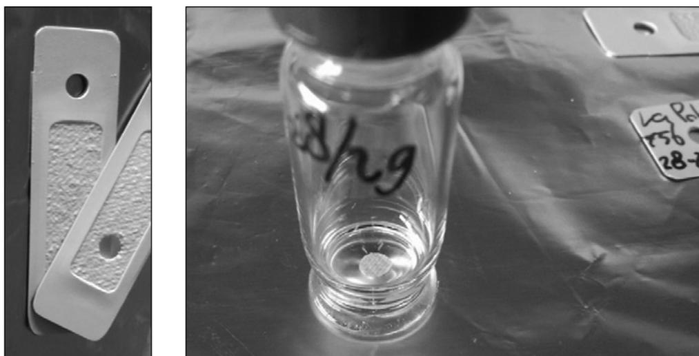
**Figura 5.** Tira de filtro de carbón negro equivalente (eBC) del microAETH AE51 y fracción de muestra en vial analítico.
