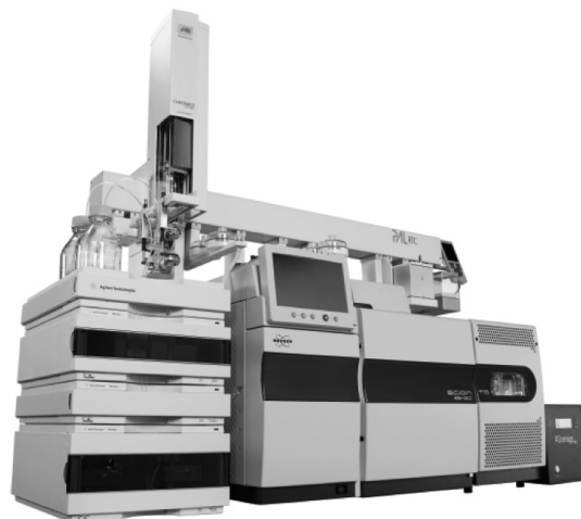
Figura 1. Sistema automatizado para la medida de PAH en productos alimenticios con acoplamiento LC-LC-GC/MS.
