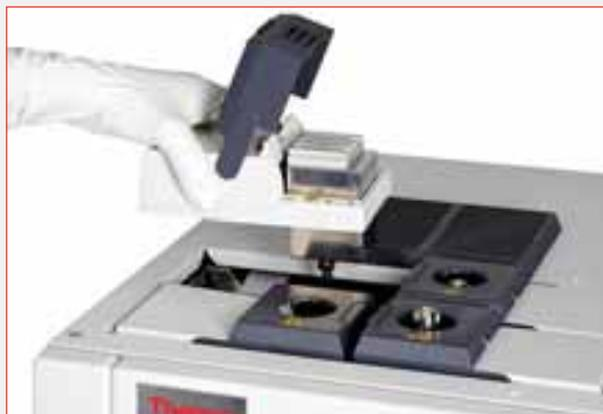
Ejemplo de instalación de un módulo de conexión inmediata por parte del usuario
