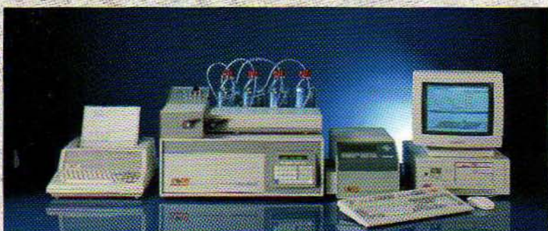
KONIK-HPLC - 500 B con detector UV-VIS de barridos espectrales.
