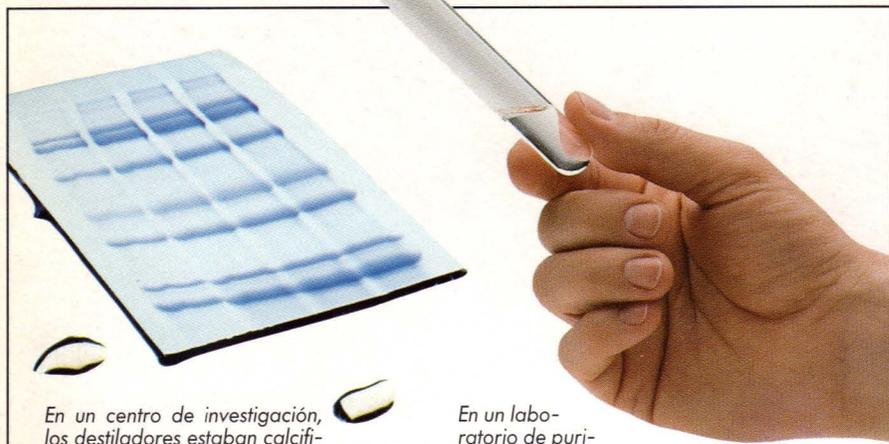
En un centro de investigación, los destiladores estaban calcificados. Se limpiaron con fosfatos, pero éstos aparecieron en el agua utilizada para preparar geles de poliacrilamida, afectando a las separaciones. La utilización de un Milli-Q Plus mejoró notablemente los resultados.
